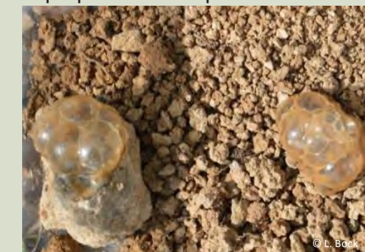
▲ Dégagement de CO 2 (effervescence) par réaction à l'HCl sur un élément grossier (à gauche) et sur la terre fine (à droite)
