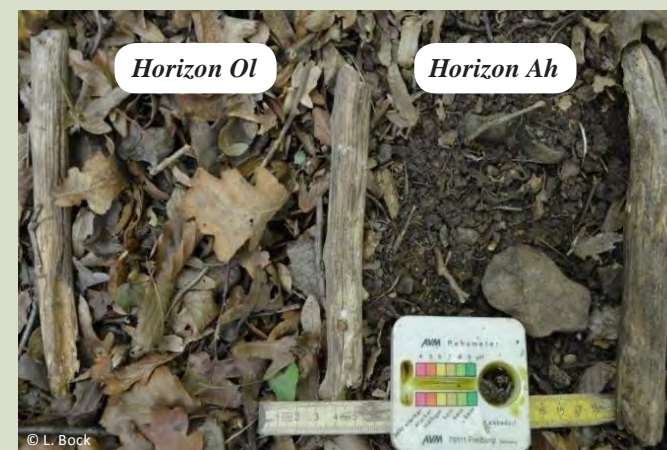
▲ De gauche à droite en section horizontale : horizon O1 et contact abrupt avec l'horizon Ah pour lequel un kit pH renseigne, par un virage au vert olive, la valeur 7
